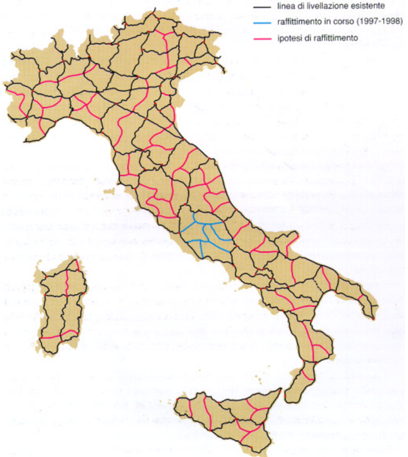
Fig. 16 - Rete nazionale di livellazione geometrica di alta precisione.
