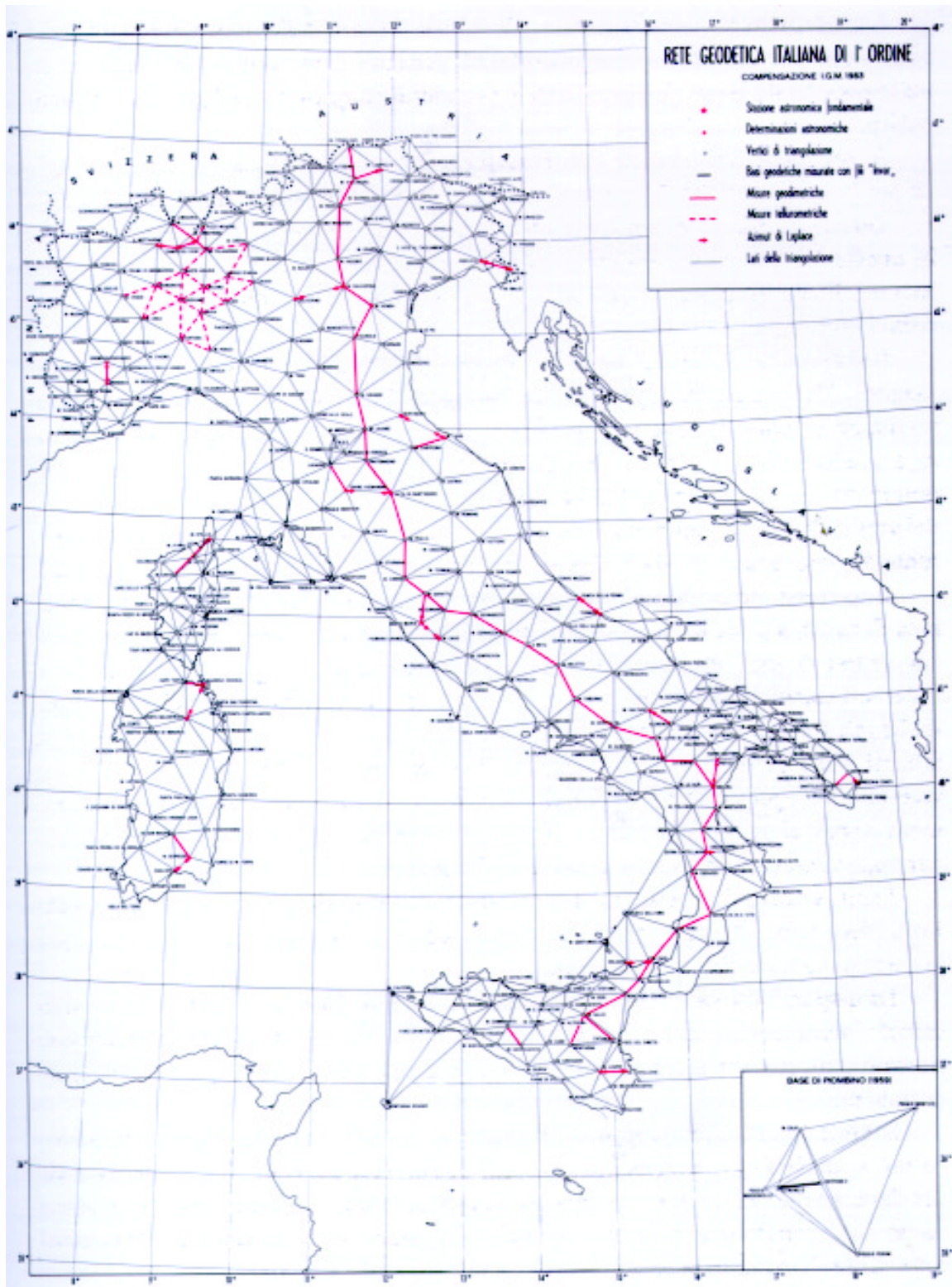
Fig. 8 - La rete geodetica fondamentale nel sistema IGM83.
